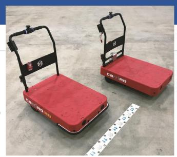
ロボットや自動運転技術を開発するZMP社製の台車型物流支援ロボット。ピッキング・工程間搬送等での運送業務をアシストします。
